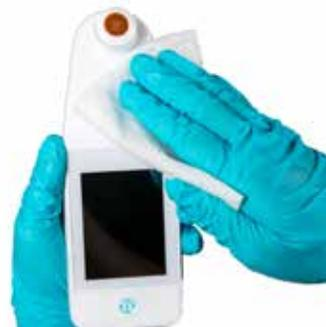
**Obrázek 27** Dezinfikování přední části skeneru
