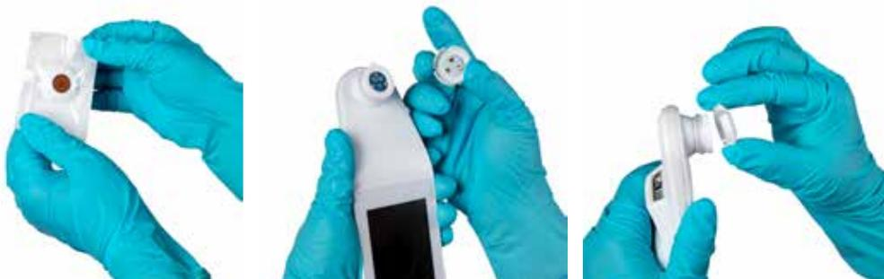
**Obrázek 14 Instalace snímače na jedno použití**
