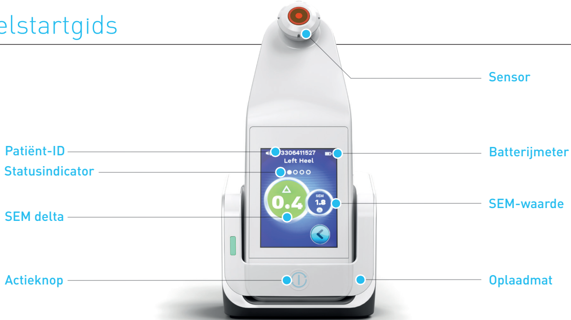
Afbeelding 1 – scherm van Provizio™ SEM Scanner
