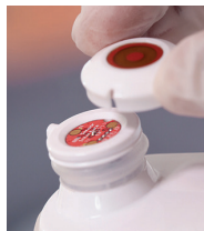
Figura 4: Instalación del sensor de escáner SEM Provizio™
