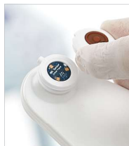
Abbildung 5 – Installieren des Provizio SEM- Scannersensors
